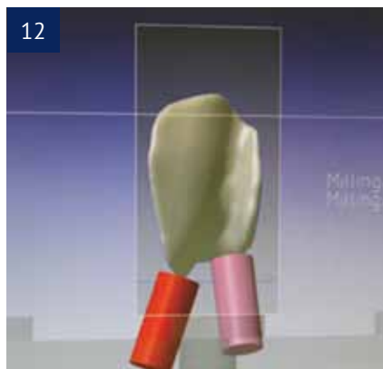
Мал. 11, 12. Цифрове моделювання процесу фрезерування після імпорту файла *.stl у CNC
